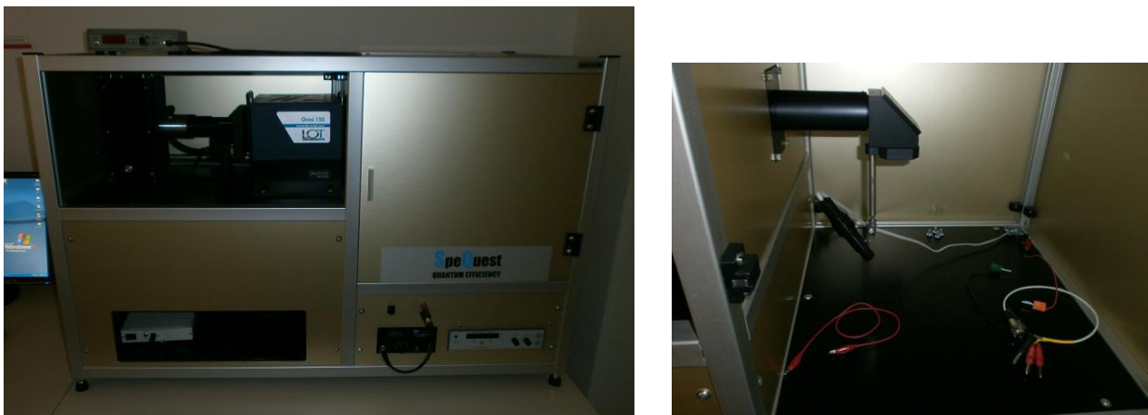
Fig.3.13: Sistema di rilevazione dell'efficienza quantica (SpeQuest) utilizzato nelle caratterizzazioni delle celle (a sinistra) e relativa area di lavoro (a destra).
