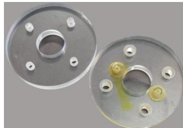
Fig.3.12: Clamping in PMMA per le celle microfluidiche.
