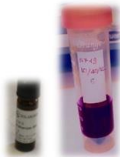
Fig.3.7: A sinistra l’N719 in polvere, a destra disciolto in etanolo.
