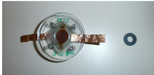
Fig.3.14: Cella DSSC e relativa maschera da 0.22cm 2 .
