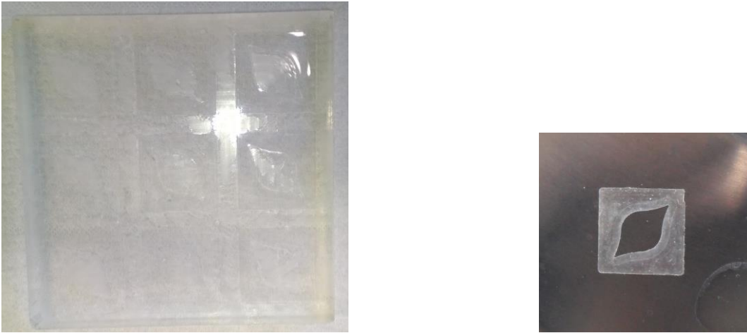
Fig.3.11: Stampo per le membrane (a sinistra) e esempio di membrana a doppia goccia (a destra).
