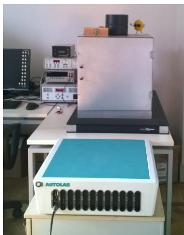
Fig.3.25: Potenziostato e Simulatore Solare.
