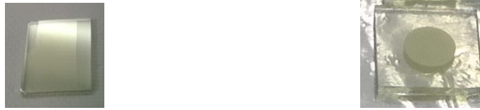
Figura 3.5: Foto-anodo dopo la PLD (sinistra) e foto-anodo di TiO 2 al termine del trattamento termico (destra).
