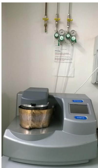
Fig.3.8: Macchina per lo Sputtering.
