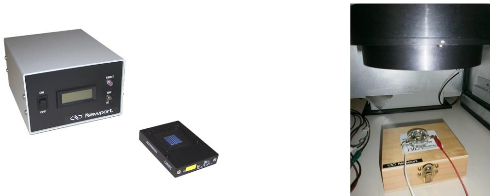
Fig.3.19: Cella solare in silicio e apparato standard per la calibrazione del simulatore (a sinistra); interno del simulatore solare dove viene posizionata la cella al Silicio per la calibrazione e la DSSC per la caratterizzazione I-V (a destra).
